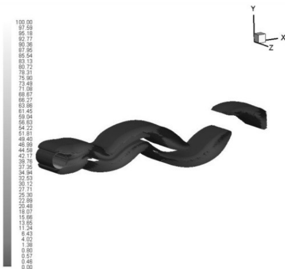
شکل ۱۲: کانتور توزیع سطوحی که دارای مقدار چرخش یکسان هستند در مدل پنس k-\omega در f_k = 0.5
