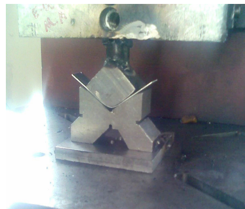
شکل ۶: (بالا) شماتیک و (پایین) تصویری از قالب ساخته شده جهت تست خمش
