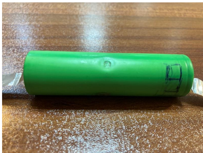
شکل ۸. سلول باتری Sony وی تی سی ۶ پس از آزمایش نفوذ مکانیکی با فشار ۵ bar تنظیم کننده و سرعت برخورد ۹/۲ m/s در دمای -25^{\circ}\text{C} که باتری توانست پایداری خود در برابر نفوذ را حفظ کند.
