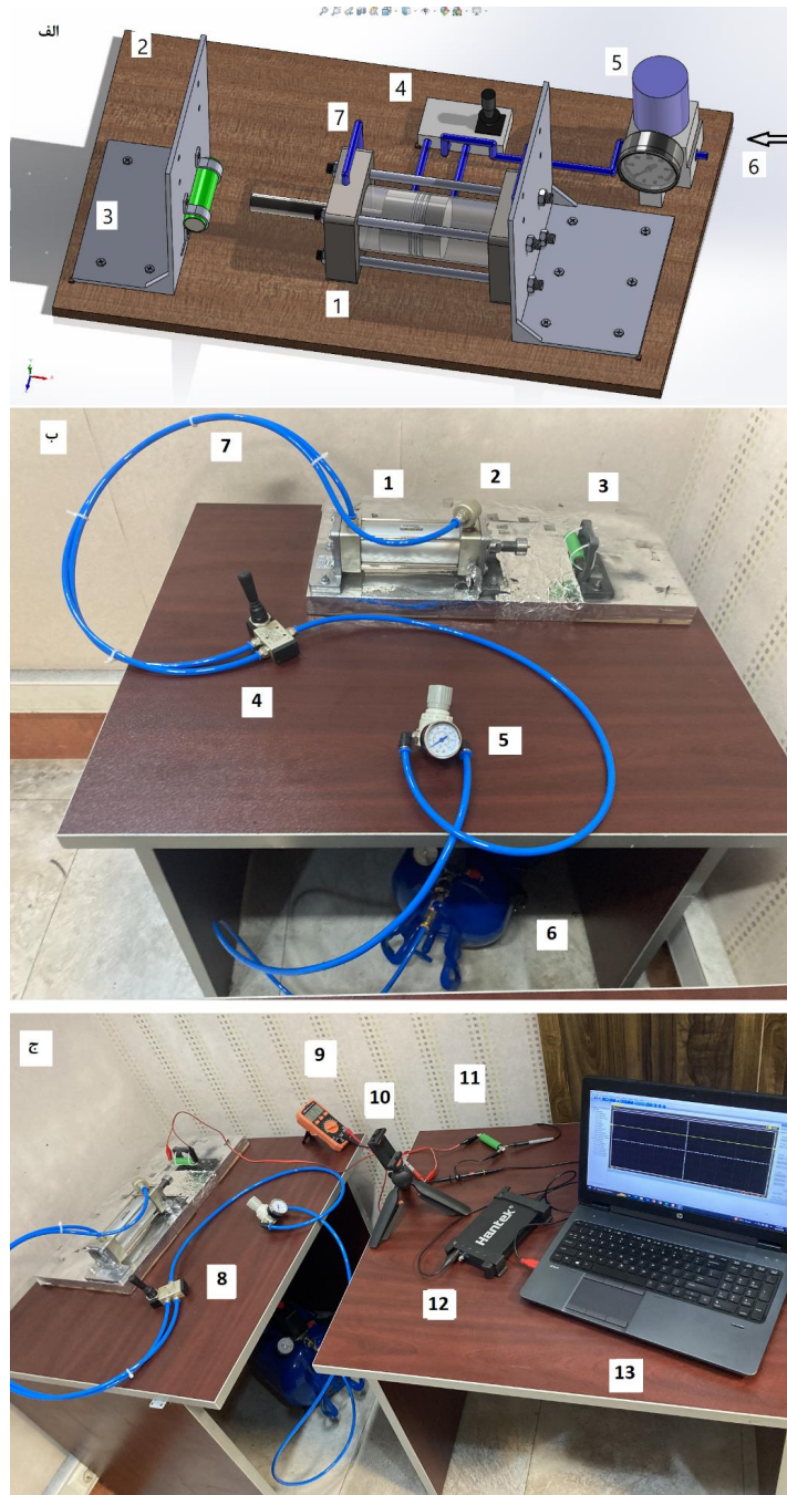
شکل ۴. طراحی سیستم ضربه در نرم افزار Solidworks (الف) و اجرای آن (ب) شامل قطعات سیلندر پنوماتیک (۱)، پایه زیرین مجموعه با پوشش ورق آلومینیوم (۲)، پایه‌های نگه دارنده جک و باتری در یک راستا (۳)، شیر دستی فشار هوا (۴)، تنظیم کننده فشار به همراه گیج فشار (۵)، کمپرسور هوا (۶)، لوله‌ها و اتصالات (۷) و بطور کلی مجموعه آزمایش و ثبت وقایع (ج) شامل سیستم ضربه (۸)، مولتی متر (۹)، دوربین حرارتی به همراه دوربین فیلمبرداری با نرخ فریم بالا به همراه پایه نگهدارنده (۱۰)، باتری موازی با باتری آزمایش ضربه برای ثبت افت ولتاژ (۱۱)، اسیلوسکوپ (۱۲) و رایانه به همراه نرم افزار اسیلوسکوپ (۱۳)
