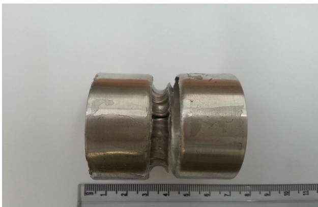
شکل ۱۵: لوله شکل‌دهی شده در آزمون تجربی برای v=6200V, t=0/6 mm, c=0/1 mm
