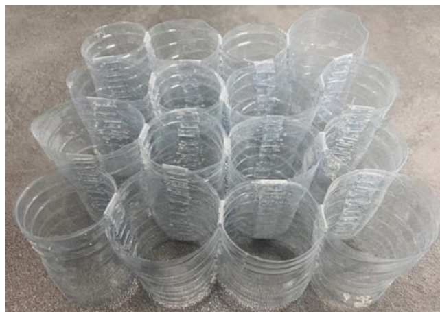
شکل ۷. تشک ژئوسل ساخته شده از بطری های پلاستیکی.
