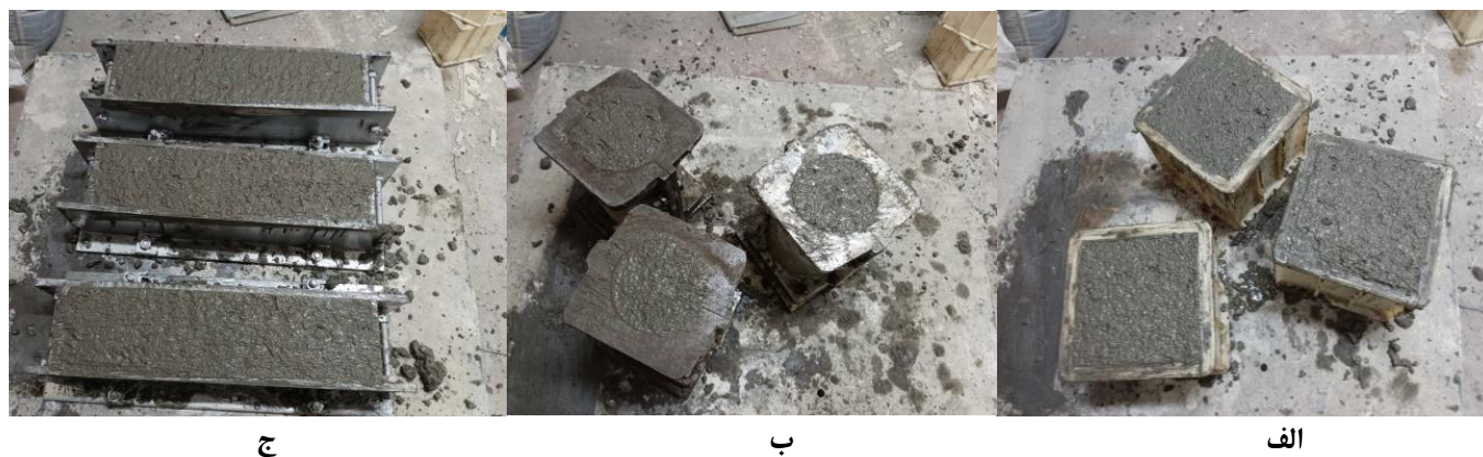
شکل ۳. نمونه‌های ساخته شده (الف) نمونه مکعبی فشاری، (ب) نمونه استوانه‌ای کششی، (ج) نمونه تیر خمشی.
