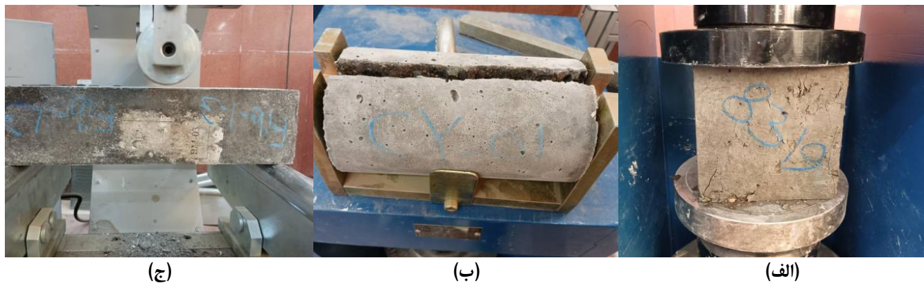
شکل ۴. نمونه‌ها تحت آزمون (الف) فشاری، (ب) کششی، (ج) خمشی.
