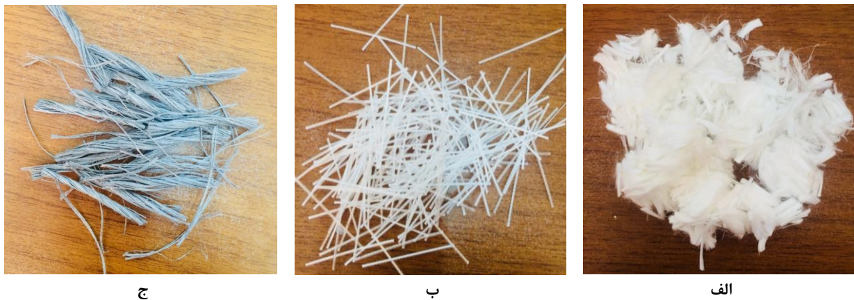
شکل ۲. الیاف مورد استفاده در طرح (الف) پلی پروپیلن، (ب) بارچیپ ۴۸، (ج) فورتافرو فرو
