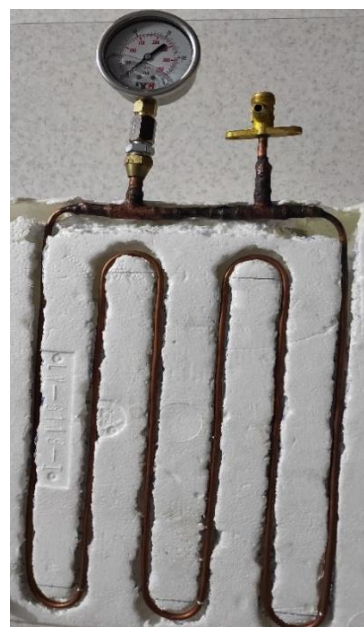
شکل ۶. ساختار لوله حرارتی نوسانی حلقه بسته پس از جوشکاری.
