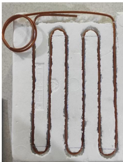
شکل ۲. ساختار لوله مسی خم شده مطابق ابعاد طرح.
