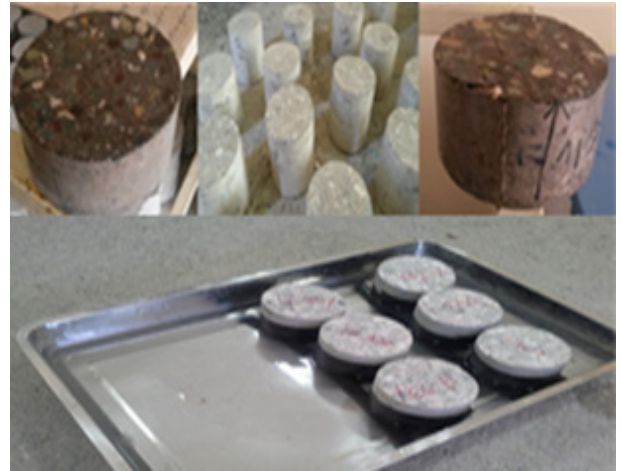
شکل ۳: نمونه‌های آزمون جذب حجمی و موئینه Fig 3. The specimens utilized in the water absorption and sorptivity tests
