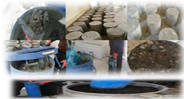
شکل ۲: مخلوط کن استفاده‌شده، نحوه تراکم با چکش تراکتور و نحوه آماده‌سازی نمونه‌های استوانه‌ای
