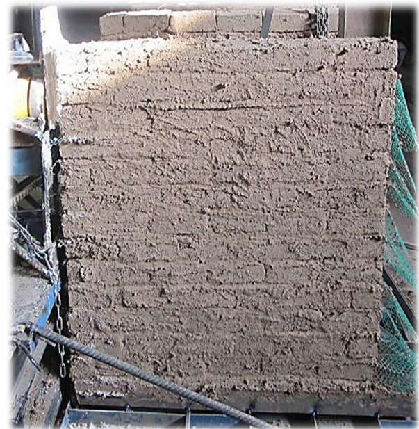
شکل ۹: دیوار قبل از آزمایش بدون بار ثقلی
