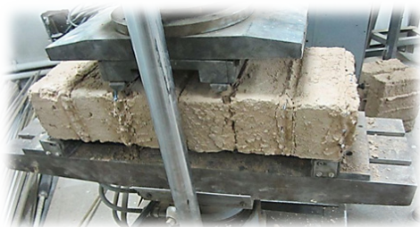
شکل ۱۳: آزمایش خمشی بر روی نمونه‌های منشوری ساخته شده با ۶ ردیف خشت
