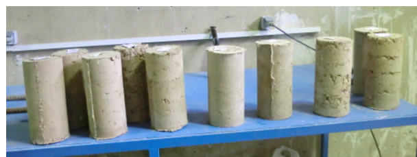
شکل ۴: نمونه‌های استوان‌های برای آزمایش برزیلی
