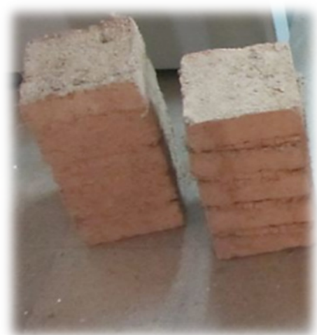
شکل ۱۲: نمونه ۵ تایی آزمایش مقاومت فشاری
