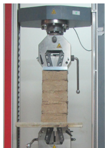
شکل ۶: آزمایش فشاری نمونه های منشوری
