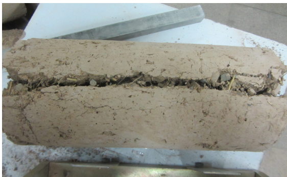
شکل ۱۱: نمونه استوانه‌ای دارای الیاف کاه بعد از آزمایش برزیلی
