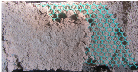
شکل ۱۷: نمونه‌ای از ملات دیوار آزمایش شده با توری پلیمری ۱۰ میلی‌متری
