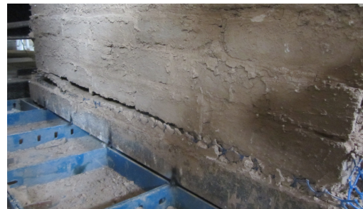
شکل ۱۵: شکل ترک ایجاد شده در آزمایش نیروی جانبی در دیوار با ملات تقویت شده با توری پلیمری ۲۵ میلی‌متری
