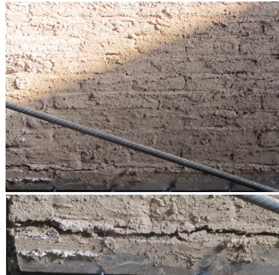
شکل ۱۶: ترک‌های ایجاد شده در دیوار مسلح شده با توری پلیمری ۱۰ میلی‌متری بعد از آزمایش
