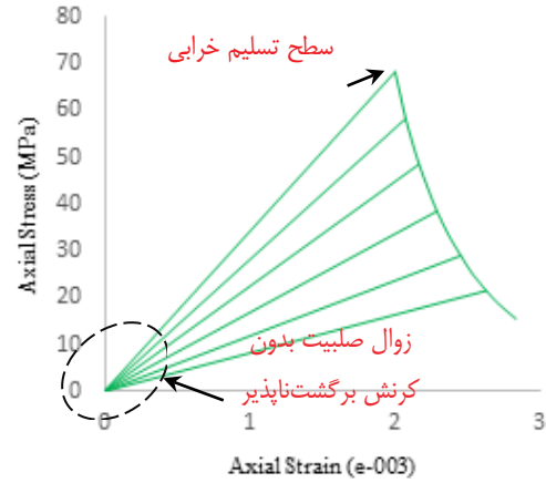
شکل ۴: منحنی تنش-کرنش شبیه سازی شده در آزمایش مقاومت فشاری تک محوره سنگ آهک اوولیتی با مدل رفتاری خرابی بدون لحاظ رفتار پلاستیک.
