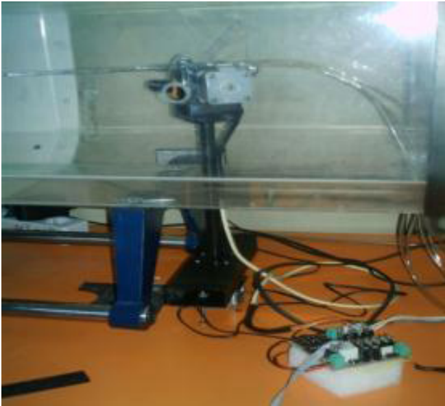
Fig. 3. Five-hole probe installed in the open loop wind tunnel شکل ۳: نمایی از کاوشگر پنج حفره بر روی دستگاه زاویه دهنده کاوشگر در تونل باد مدار باز
