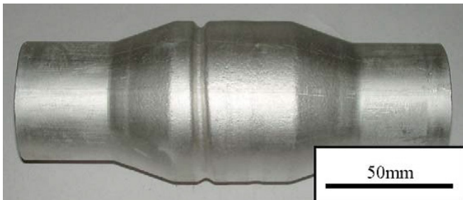
Fig. 13. Wrinkled part at the end of process [17] شکل ۱۳: قطعه چروک شده در پایان فرآیند [۱۷]
