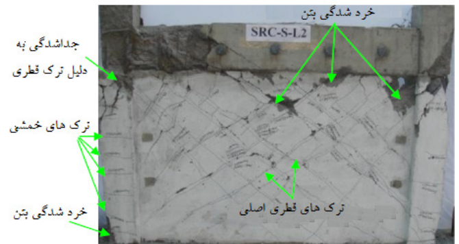
شکل ۴: نمایش آسیب دیدگی مدل آزمایشگاهی [۲۳]
