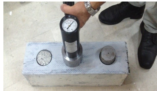
شکل ۵: آزمایش مقاومت چسبندگی بر روی ورق‌های کامپوزیتی
