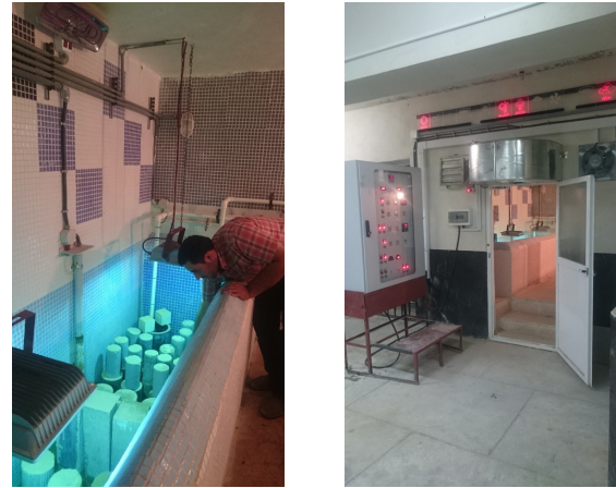
شکل ۳: (الف) نمای بیرونی از محیط شبیه‌ساز خلیج فارس (ب) نمونه‌های قرار گرفته داخل حوضچه‌ی محیط شبیه‌ساز خلیج فارس
