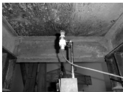
شکل ۳: نحوه قرارگیری دستگاه تغییر مکان‌سنج زیر نمونه
