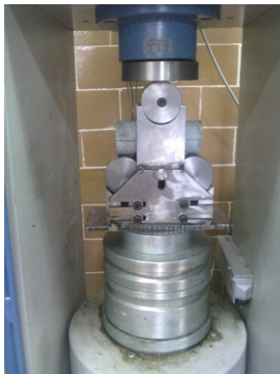
شکل ۴: دستگاه مخصوص آزمایش خمش سه نقطه‌ای که در زیر دستگاه اعمال بارمحوری قرار گرفته
